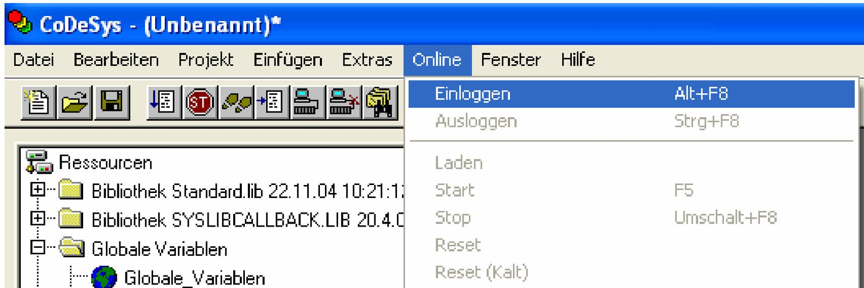
Anschließend kann über Online und Einloggen eine Verbindung vom PC zum WAGO-Controller erfolgen..
