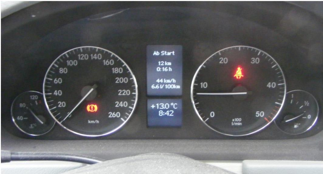
**Abb. 1.1 Verbrauchsanzeige im Auto mit Routenverlauf**
