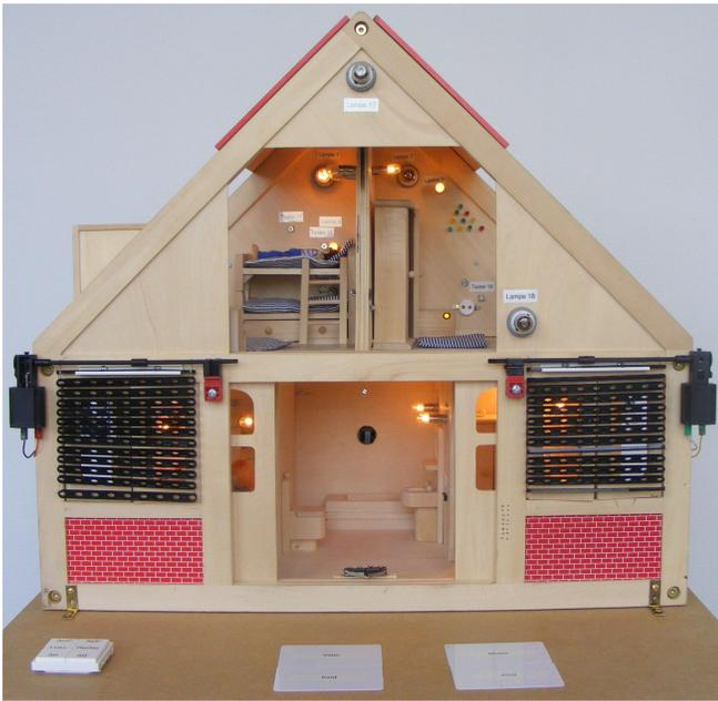
Das LCN-Demonstrationsmodell verfügt über eine Gebäudeautomation mit Komfort-, Sicherheits- und Energiesparfunktionen. Die Beleuchtung wird zum Teil geschaltet und gedimmt, eine Konstantlichtregelung ist implementiert. Zur Einzelraumtemperaturregelung wird in jedem Raum die Temperatur gemessen.
