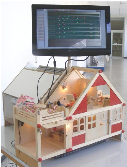
So kann die Gebäudeautomation zeit-, temperatur- und helligkeitsgesteuert Verbraucher zu- und abschalten, bei geöffneten Fenstern Heizkörper abschalten, bei Abwesenheit die Anwesenheit durch intervallgesteuertes Schalten von Lampen die Anwesenheit simulieren und das Haus überwachen und Einbrüche melden.
