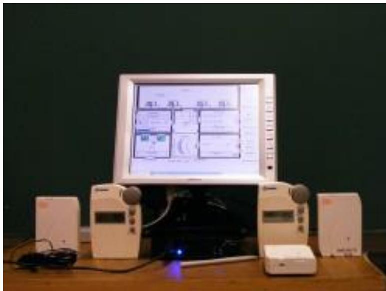
Hardware des SmartMetering-/Energiemanagement-/Gebäudeautomationssystem
