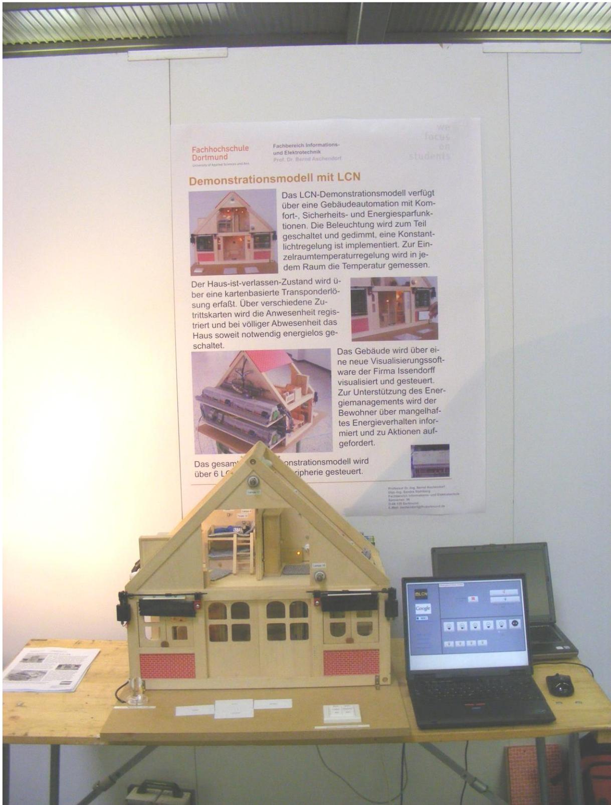
Das Demonstrationssystem eines Gebäudeautomations-/ Energiemanagement-Systems auf der Basis von LCN präsentierte die Anwendung von aktivem und passivem Energiemanagement ohne SmartMetering-Einbindung, die jedoch über http eingekoppelt werden konnte. Neben einer vollständigen Gebäudeautomation war ein Transpondersystem zur Zugangs- und Anwesenheitsüberwachung integriert.
