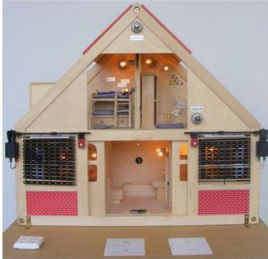
Das LCN-Demonstrationsmodell verfügt über eine Gebäudeautomation mit Komfort-, Sicherheits- und Energiesparfunktionen. Die Beleuchtung wird zum Teil geschaltet und gedimmt, eine Konstantlichtregelung ist implementiert. Zur Einzelraumtemperaturregelung wird in jedem Raum die Temperatur gemessen.
