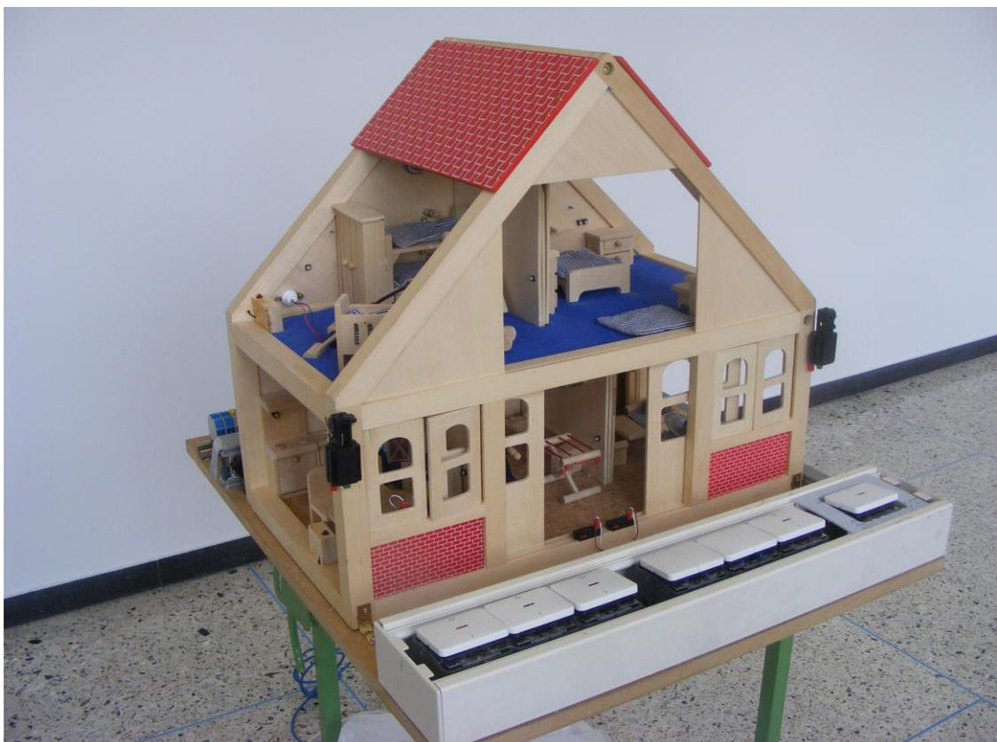
SmartMetering-/Energiemanagement-/Gebäudeautomations-system auf der Basis einer WAGO-SPS
