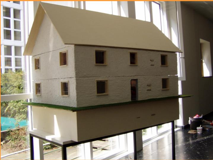
ein Einfamilienhaus mit Ingenieurbüro als zweistöckiges Gebäude mit Keller und Dach im Maßstab 1:10 gebaut und mit einer umfangreichen Elektroinstallation ausgestattet, derzeit sind Lichtsteuerung, Steckdosen, etc. fertiggestellt, in Vorbereitung sind simulierte Heizungssteuerung, Einbindung einer Photovoltaikanlage, eine thermische Solaranlage und eine Zentralsteuerung. Da die direkte Unterbringung von Busankopplern in einem 1:10-Projekt un-
