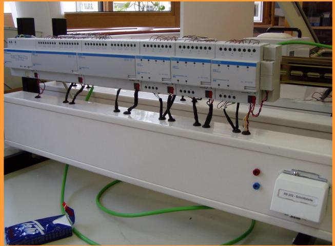
Im Rahmen eines Diplomarbeitprojekts werden die zur Verfügung stehenden Funktionalitäten von Siemens S7-300-, S7-200- und Logosystemen hinsichtlich der Anwendbarkeit in der Gebäudesystemtechnik untersucht. Darüberhinaus wird die Einbindbarkeit dieser großen oder kleinen SPS-Subsysteme in EIB-Installationen über Gateways analysiert.
