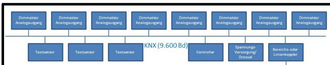
Linienstruktur eines dezentralen Gebäudeautomationssystems
