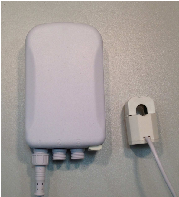
Abbildung 16 Aeon Labs Home Energy Meter mit einer Messklemme
