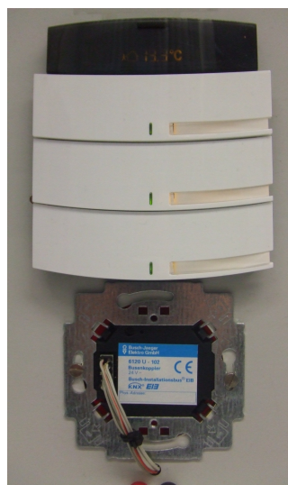
Abbildung 16: Busch-Jaeger 3-fach-Triton mit Raumtemperaturregler
