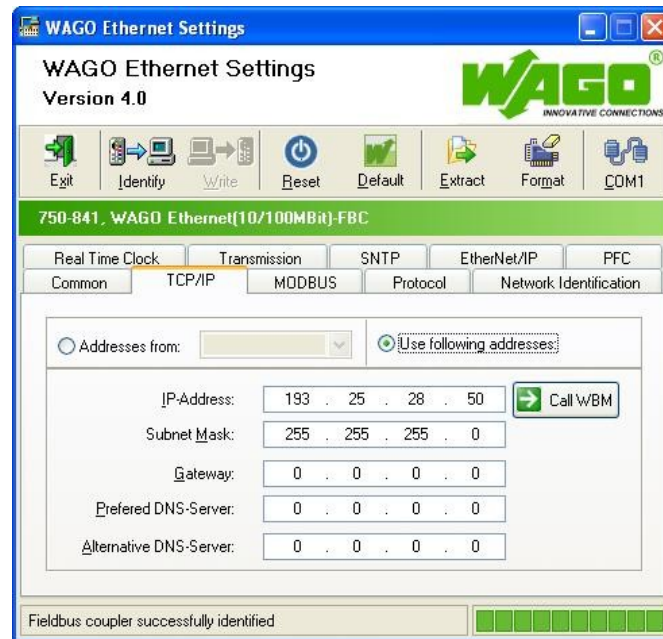
Abbildung 20: Einstellung der IP-Adresse des Controllers
