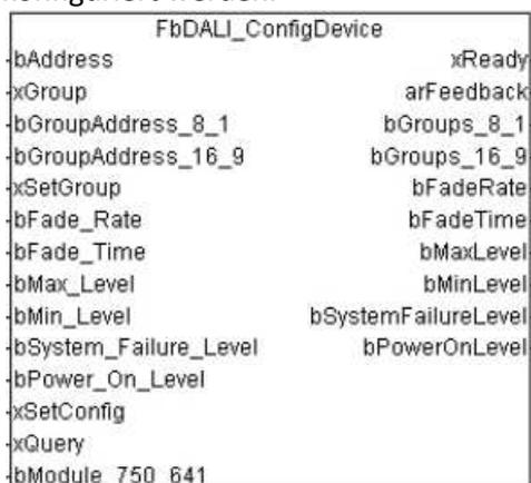
Abbildung 9: Funktionsbaustein `FbDALI_ConfigDevice`
