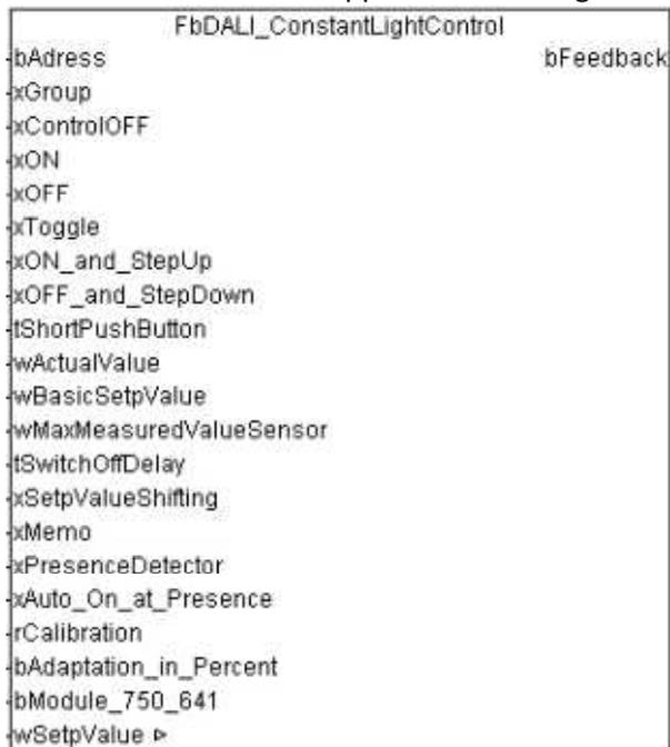
Abbildung 4: Funktionsbaustein FbDALI\_ConstantLightControl
