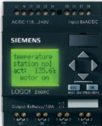
Die Logo!Basic 230 RC ist ein universelles Logikmodul der Firma Siemens. Die Basic ist die Schnittstelle für die Erweiterungsmodule (DM und AM), Programmmodule und PC-kabel. Sie besitzt ein Display und Steuerungscursor für die Benutzung des Menüs und zur Programmierung des Anwenderprogramms. Sie hat 8 Digitale Eingänge und 4 potentialfreie Ausgänge. Sie erfüllt die Norm VDE 0631, IEC 61131-2, und die Anforderung nach Norm AS/NZS 2064
