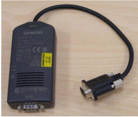
Abb. Fehler! Kein Text mit angegebener Formatvorlage im Dokument..3 Siemens S7-300-Kommunikationsadapter
