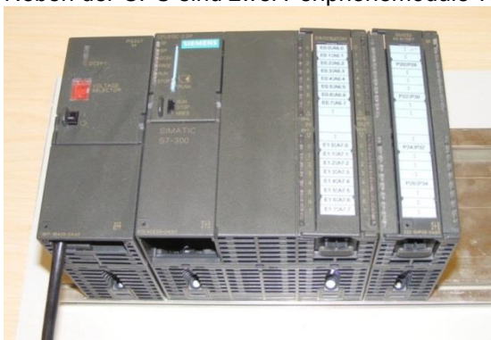
Abb. Fehler! Kein Text mit angegebener Formatvorlage im Dokument..2 SPS-System Siemens S7-300 mit I/O-Peripherie
