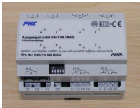
Abb. Fehler! Kein Text mit angegebener Formatvorlage im Dokument..6 PEHA-PHC-8fach-Ausgangsmodul
