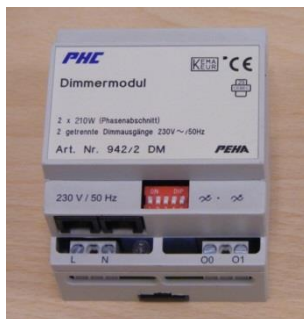
Abb. Fehler! Kein Text mit angegebener Formatvorlage im Dokument..7 PEHA-PHC-2fach-Phasenabschnittsdimmer
