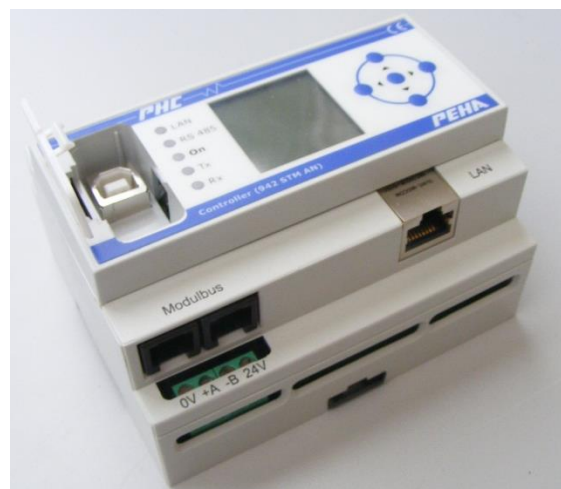
Abb. Fehler! Kein Text mit angegebener Formatvorlage im Dokument..3 PEHA-PHC-Steuereinheit (rechts mit LAN-Zugang)
