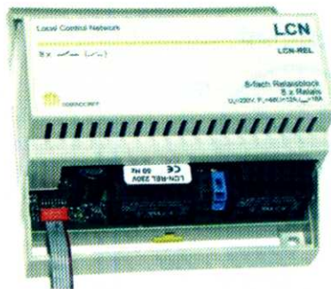
Bild 3: ... und steuert über einen Steckanschluss ein Relaismodul mit acht Schaltausgängen
