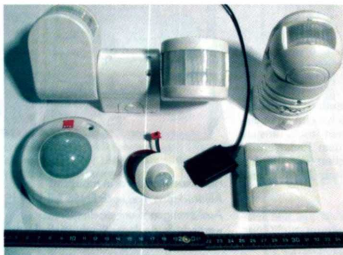
Bewegungsmelder im Größenvergleich: Die beiden Melder in der oberen Reihe sind für den Außeneinsatz vorgesehen (BEG). Links unten ein BEG-Präsenzmelder für die Deckenmontage; rechts unten einer für die UP-Dose (Jung). In der Mitte der LCN PIR-Melder und die Antenne des LCN-Radarmelders.
