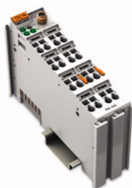
Abb. Fehler! Kein Text mit angegebener Formatvorlage im Dokument..4 Unidirektionale EnOcean-Ankopplung an die WAGO-SPS über die Klemme 750-642
