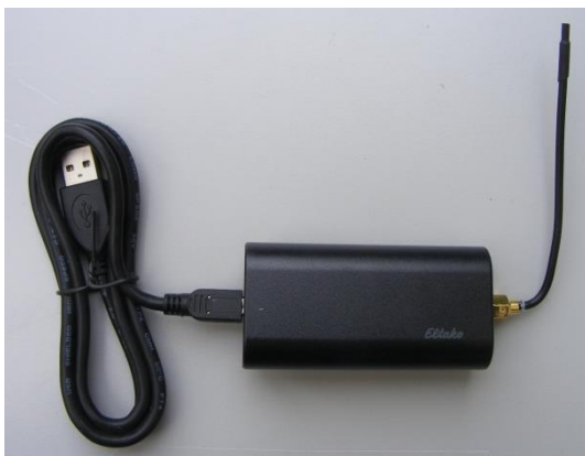
Abb. Fehler! Kein Text mit angegebener Formatvorlage im Dokument..1 EnOcean-Gateway mit USB-Anschluß
