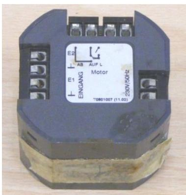
**Abb. Fehler! Kein Text mit angegebener Formatvorlage im Dokument..2 Rademacher homeline Jalousieaktor mit zwei Tastereingängen**
