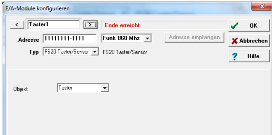
**Abb. Fehler! Kein Text mit angegebener Formatvorlage im Dokument..16 Zuordnung eines FS20-Funksensors zum Objekt Taster**
