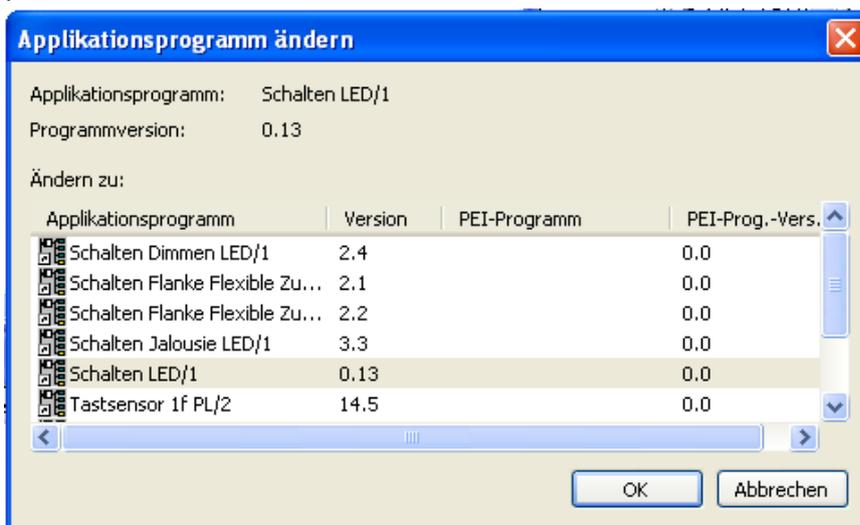
Wenn der Taster eine LED besitzt kommt es auf die Applikation an, ob diese direkt mit der Wippe verknüpft ist das heißt dann leuchtet wenn die Wippe bedient wird oder eine echte Rückmeldung vom Aktor erfolgen muss, damit die LED aufleuchte bzw. ihre Farbe wechselt. Der Aktor muss hierbei eine Rückmeldefunktion besitzen und für die Rückmeldung muss eine Gruppenadresse angelegt werden.
