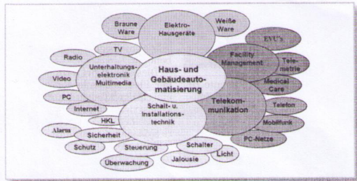
Bild 1: Umfang der heute möglichen Gebäudeautomatisierung
