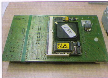
Bild 5: Eingesteckte Kontron-Controller-Platine auf der Unterseite der Basisplatine
