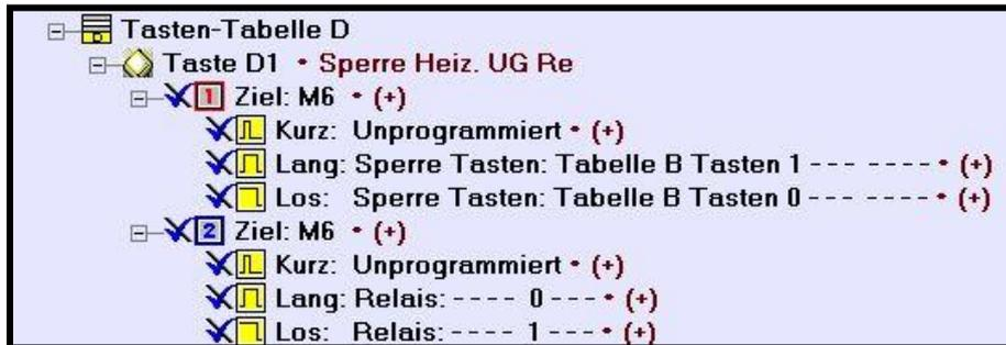
Abb. Fehler! Kein Text mit angegebener Formatvorlage im Dokument..51 Programmierung Heizung sperren
