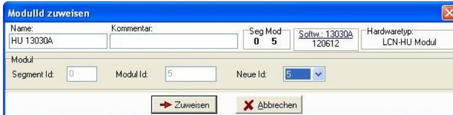
**Abb. Fehler! Kein Text mit angegebener Formatvorlage im Dokument..6 Zuweisung einer LCN Modul Id**
