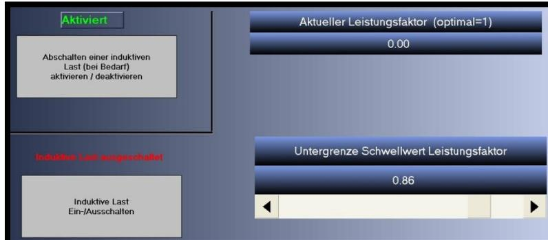
**Abb.** Fehler! Kein Text mit angegebener Formatvorlage im Dokument..30 Leistungsfaktorgesteuerter Lastabwurf
